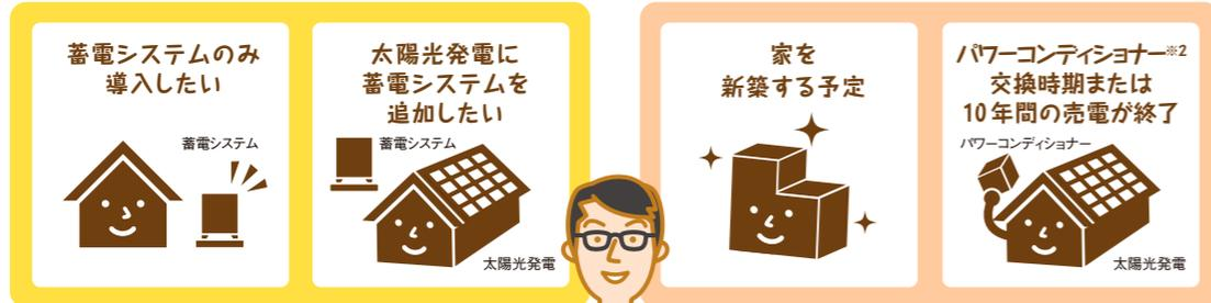
※2 パワーコンディショナーとは、太陽光で発電した直流の電気を家庭で使える交流に変換する装置です。
